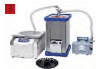
Fornito con trappola fredda (volume 2 litri, temperatura -50°C, coperchio invetro resistente ai solventi con attacco per vuoto DN16 ed un rotore per 24 provette 10/15 ml - altri rotori disponibili come accessori opzionali, vedere la lista sotto.
