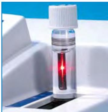
L'identificazione automatica della provetta permette un'analisi facile e veloce.
