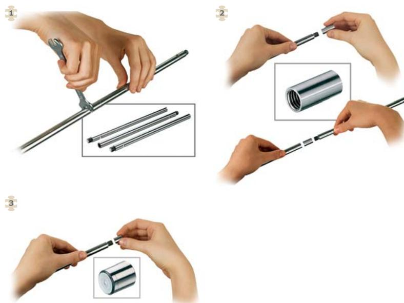
Aste in acciaio inox 18/8 con doppia filettatura interna ed esterna M10. L'altezza dell'asta può essere decisa dall'utilizzatore in quanto le aste sono avvitabili tra di loro, mentre con gli opportuni raccordi di prolungamento o di chiusura superiore si completa il sistema. Le aste M10 si fissano sulle diverse basi tramite blocco del morsetto.
