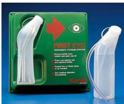
Bottiglia in polietilene. Munita di vaschetta oculare dotata di coperchio che permette un rapido e comodo lavaggio degli occhi. Un dischetto forato, posto al centro della vaschetta, rompe il getto dell'acqua, in modo da distribuirlo uniformemente sull'occhio. Un tubicino scarica all'esterno il liquido che ha lavato l'occhio.
