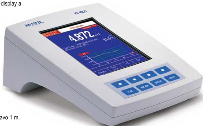
I modelli HI 4221 e HI 4222 sono forniti completi di alimentatore ed istruzioni, elettrodo pH (HI 1131B), sonda di temperatura (HI 7662-T), alimentatore 12Vdc, soluzioni di calibrazione pH 4,01 e 7,01 (20 ml cad.), soluzione elettrolitica, stativo porta-elettrodi (HI 76404N), agitatore magnetico ed istruzioni.
