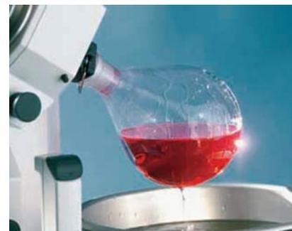
**La valvola di sfiato** integrata consente l'interruzione immediata dell'evaporazione premendo un solo tasto. Senza corrente, la valvola è aperta al fine di evitare una sovrappressione nel sistema. I materiali utilizzati sono esclusivamente PEEK e Kalrez, in quanto garantiscono un'elevatissima resistenza chimica.
