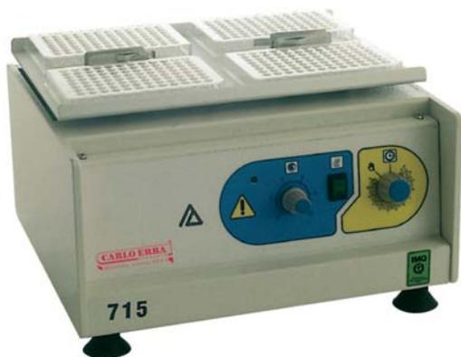
Aggitatore a vibrazione rotatoria (eccentricità 3,7 mm) predisposto per contenere fino a 4 piastre Microtiter fissate con molla. Possibilità di alloggiare, a richiesta, 8 piastre. Regolazione elettronica della velocità con funzionamento in continuo o prefissato mediante timer fino a 60 min. Costruzione esterna in acciaio con verniciatura in polvere antiacido. Interruttore bipolare. Fusibili di protezione. Conforme alle norme CEI 61010 e IMQ.
