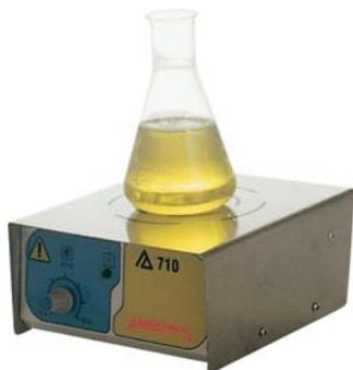
Agitatore magnetico con piano superiore in acciaio inox, in grado di sostenere recipienti di notevole capacità, particolarmente indicato per lavori continuativi. Costruzione esterna in acciaio inox con verniciatura in polvere antiacido. Regolazione elettronica della velocità con funzionamento continuo e silenzioso. Fornito completo di ancorotta magnetica rivestita in PTFE con Ø 6 mm e lunghezza 35 mm. Conforme alle norme CEI EN 61010-1 (IEC1010-1/CEI 66-5).
