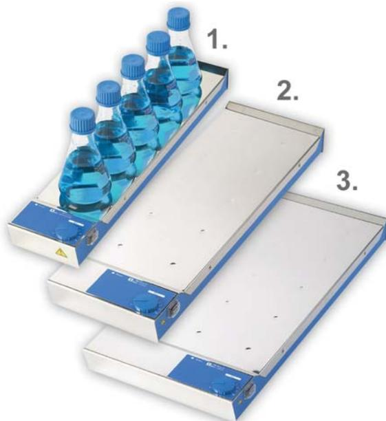
Agitatori magnetici a ricettacoli multipli senza riscaldamento. La finitura in acciaio inossidabile (AISI 304), si estende anche all'apparecchio, agevolando in modo tale le operazioni di pulizia ed impedendo la penetrazione di liquidi.
