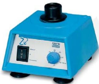
Agitatore a vibrazione studiato per la miscelazione di soluzioni in provette o piccoli palloni mediante un movimento circolare e oscillante.
