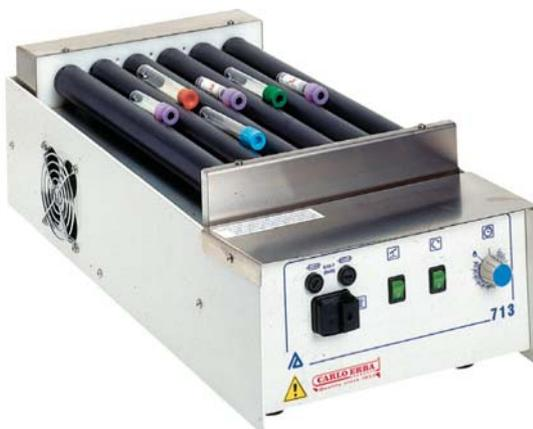
Adatto per provette e flaconi di varie dimensioni, dotato di un duplice movimento rotativo e/o oscillatorio. L'apparecchio è provvisto di 6 rulli in PVC antiscivolo Ø 30 mm. Velocità 60 giri/minuto e 12 oscillazioni al minuto con ampiezza di 32 mm. Pannello frontale dotato di selettore per funzionamento in continuo o prefissato mediante timer fino a 60' ed interruttore per funzionamento rotativo e/o oscillatorio. Costruzione esterna in acciaio con verniciatura in polvere.
