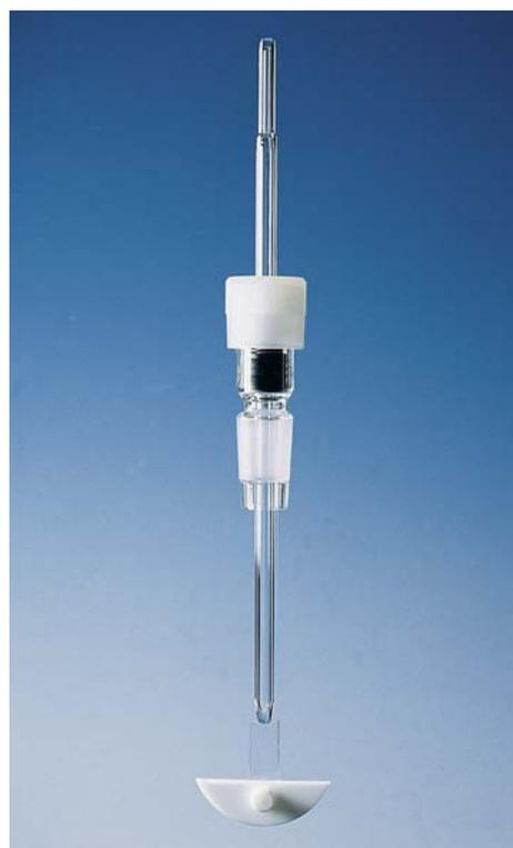
Asta di agitazione in vetro Duran con paletta in PTFE. L'adattatore ne consente l'inserimento in apparecchiature di agitazione con tenuta di vuoto fino a 10-2 mbar. In queste condizioni il sistema funziona in continuo fino a 800 rpm. Adatto per palloni a fondo sferico da ml 250 a 2000, cono SN 29/32.
