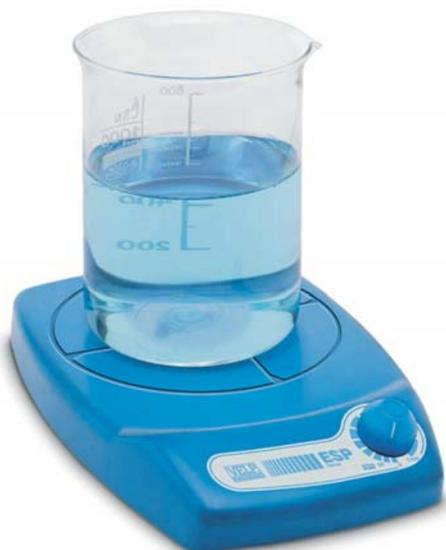
Agitatore magnetico ultrapiatto, senza elementi meccanici in movimento, che non richiede manutenzione. Il punto di agitazione, regolabile mediante microprocessore, è costituito da bobine che inducono un campo magnetico rotante.
