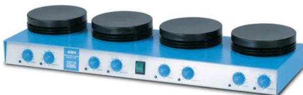
Agitatore magnetico riscaldante a 4 posti comandati separatamente con regolazione elettronica della temperatura. Le piastre riscaldanti sono costruite in lega d'alluminio e rivestite con una speciale protezione nera che assicura un'uniforme distribuzione del calore su tutta la superficie, con un'ottima resistenza agli aggressivi chimici.
