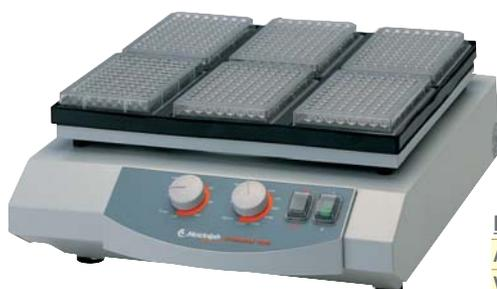
Agitatore per n. 6 piastre a pozzetto o similari, robusto e affidabile, con velocità regolabile e timer con segnale acustico. Il motore incapsulato non trasmette il minimo calore alle piastre agitate. L'orbita di soli 1,5 mm non consente contaminazioni tra una cella e l'altra anche se piene. L'alta affidabilità dello strumento consente una garanzia di tre anni! Può essere integrato in maniera economica all'Incubator 1000 per la termostatazione alla temperatura desiderata.
