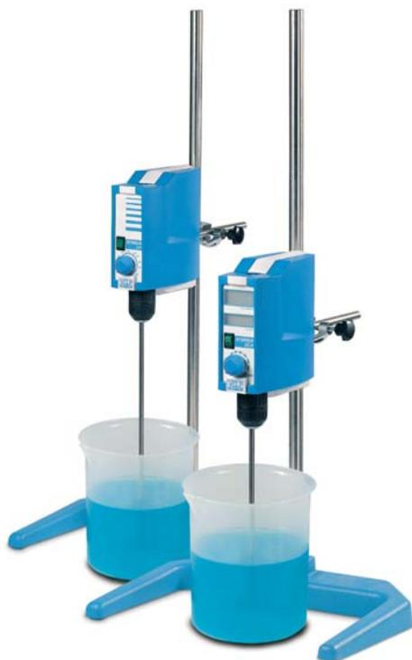
Gli agitatori ad asta modello LH e DLH sono caratterizzati da una forte coppia di rotazione che ne permette l'impiego con liquidi ad alta viscosità (max 50000 mPa x sec). Il motore, dinamico e potente, di provata resistenza e robustezza, viene controllato da un microprocessore il quale permette il mantenimento di una velocità costante anche al variare della viscosità del liquido agitato. Preselezione dei giri da 50 a 2000 rpm.
