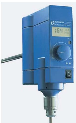
Agitatore da laboratorio digitale a coppia elevata per alta viscosità.
