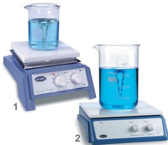
Agitatori con piastra in ceramica facile da pulire e resistente alla corrosione. Blocco automatico della temperatura per evitare il surriscaldamento. Zona centrale evidenziata per permettere l'immediata collocazione del recipiente in prossimità della zona riscaldata e parte frontale inclinata per una migliore lettura dei dati. Idonei per agitare volumi fino a 15 litri.
