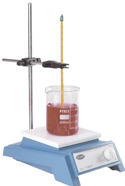
Caratterizzato da una piastra d'appoggio in ceramica bianca, resistente alla corrosione e idonea all'osservazione di variazioni di colore durante, per esempio, reazioni di titolazione. Motore dotato di potente magnete ed un piano d'appoggio tali da permettere di agitare fino a volumi di 15 litri. Parte frontale inclinata per una migliore lettura dei dati. Foro per l'attacco di un'asta da mm 10 di diametro. Fornito con una confezione di ancorette.
