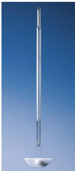
Agitatore a siringa in vetro borosilicato. Il modello completo è costituito da un'asta di agitazione e da una guida intercambiabile in vetro a tenuta di vuoto. La smerigliatura normalizzata SN 29/32 del raccordo, permette l'adattamento su palloni. Asta con paletta a forma di mezzaluna in PTFE, lunghezza totale dell'asta mm 420, diametro massimo della paletta mm 50, diametro asta per connessione mm 10.
