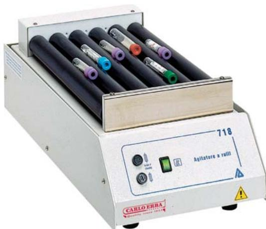
Particolarmente indicato per mantenere in idonea agitazione provette con sangue intero per indagini ematologiche. Costruzione esterna in acciaio con verniciatura in polvere, dotato di 6 rulli in PVC antiscivolo Ø 30 mm. Velocità dei rulli 60 giri/minuto e 45 oscillazioni al minuto, con ampiezza di 28 mm.
